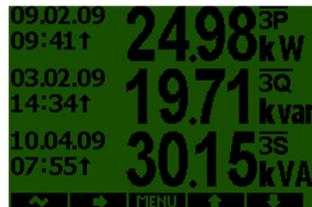
Abb. 5.12 : Maxima der Durchschnittswerte Die Maxima & Minima werden auf der linken Seite des Fensters Durchschnittswerte angezeigt- der Maximalwert ist definiert mit dem Symbol \uparrow und Minimalwert mit dem Symbol \downarrow .
