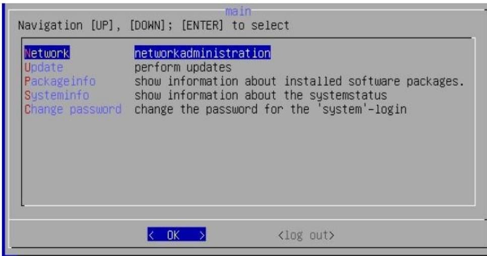
Wählen Sie hier die “Network” Option aus um die Netzwerkkonfiguration aufzurufen. Stellen Sie den Typ auf DHCP um die Konfiguration automatisch auszuführen. *Hinweis: Beachten Sie, dass ENVIS-Web für den reibungslosen Ablauf eine statische IP-Adresse benötigt. Falls Sie also eine Zuweisung über DHCP vornehmen stellen Sie bitte sicher, dass ihr DHCP Server eine Reservation für das ENVIS-Web bereitstellt.*
