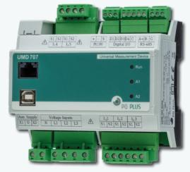
Das UMD 707RCM, überwacht mit entsprechenden Differenzstromwandlern 5-kanalig Ihre Fehlerströme, die Spannungsqualität u.a. nach EN 50160 und EN 61000-2-4 sowie die Oberschwingungen bis zur 128. Harmonischen (optional auch die Supraharmonischen von 2 kHz bis 9 kHz).
