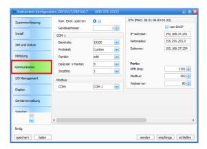
Des Weiteren können die Parameter für die Modbus-Kommunikation angepasst werden:
