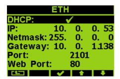
Wenn Sie die nötigen Einstellungen getroffen haben, bestätigen Sie diese mit der Taste 3 und gehen durch mehrfaches Betätigen der Taste 1 zurück in das Hauptmenü.
