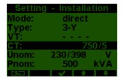
6. Wenn Sie die nötigen Einstellungen getroffen haben, bestätigen Sie diese mit der Taste 3 und gehen durch mehrfaches Betätigen der Taste 1 zurück in das Hauptmenü. Die folgende Abfrage bestätigen Sie mit Taste 2.
