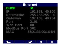
Wenn Sie die nötigen Einstellungen getroffen haben, bestätigen Sie diese mit der Taste 3 und gehen durch mehrfaches Betätigen der Taste 1 zurück in das Hauptmenü. Die folgende Abfrage bestätigen Sie mit Taste 2.
