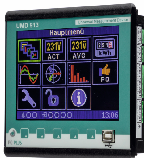
Das Messgerät UMD 913 dient zur lückenlosen und hochpräzisen Überwachung von Sonderkundenanlagen in Kl. A (IEC 61000-4-30) sowie zur Überwachung der Supraharmonischen im Frequenzband von 2 bis 9 kHz
