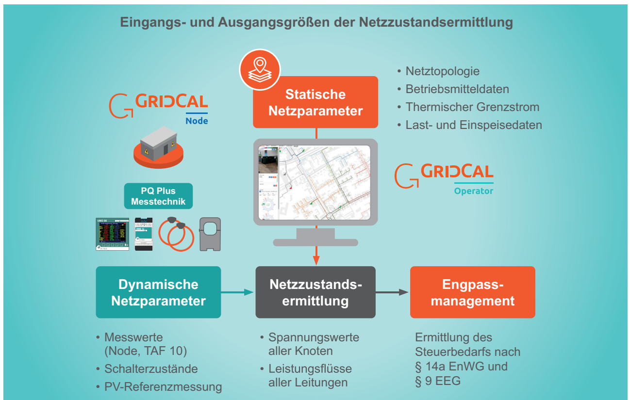
Bild 1. Eingangs- und Ausgangsgrößen der Netzzustandsermittlung
